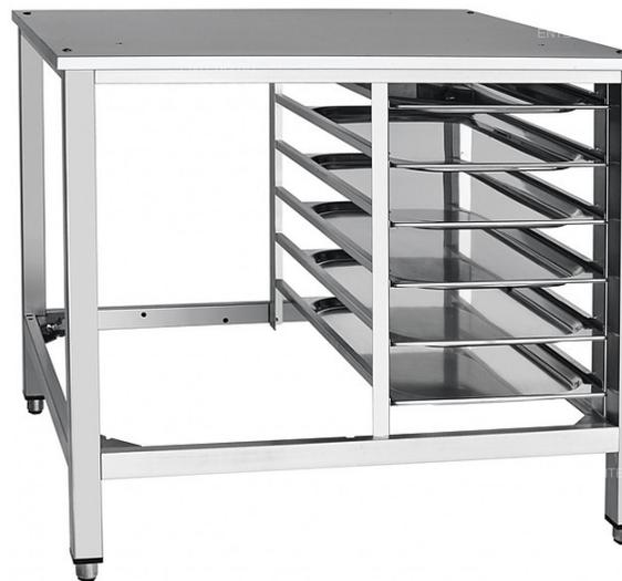
Подставка **\*\*Abat ПК-6МФ\*\*** используется совместно с пароконвектоматом ПКА 6-1/1 ПМФ на морских судах, на площадках в открытом море и на береговых линиях. Модель оснащена направляющими специальной формы, предотвращающие самопроизвольное выкатывание гастроемкостей при качке и регулируемые по высоте ножками с резиновыми вставками.
